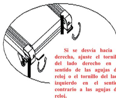
Si se desvía hacia la derecha, ajuste el tornillo del lado derecho en el sentido de las agujas del reloj o el tornillo del lado izquierdo en el sentido contrario a las agujas del reloj.
