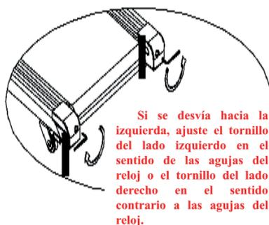
Si se desvía hacia la izquierda, ajuste el tornillo del lado izquierdo en el sentido de las agujas del reloj o el tornillo del lado derecho en el sentido contrario a las agujas del reloj.
