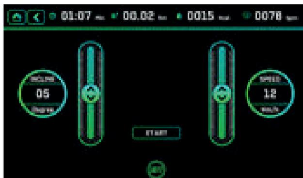
**Clarification :** Certains modèles n'ont pas de fonction d'inclinaison, donc l'interface utilisateur n'affiche pas la fonction de réglage de l'inclinaison.
